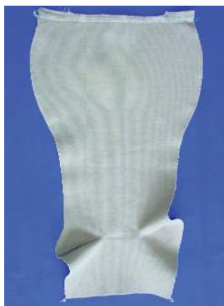
OBRAZ 3 Wyrób płaskodziany (przed zszyciem): kształt wyrobu powstaje poprzez dodawanie lub odejmowanie igieł podczas dziania.
